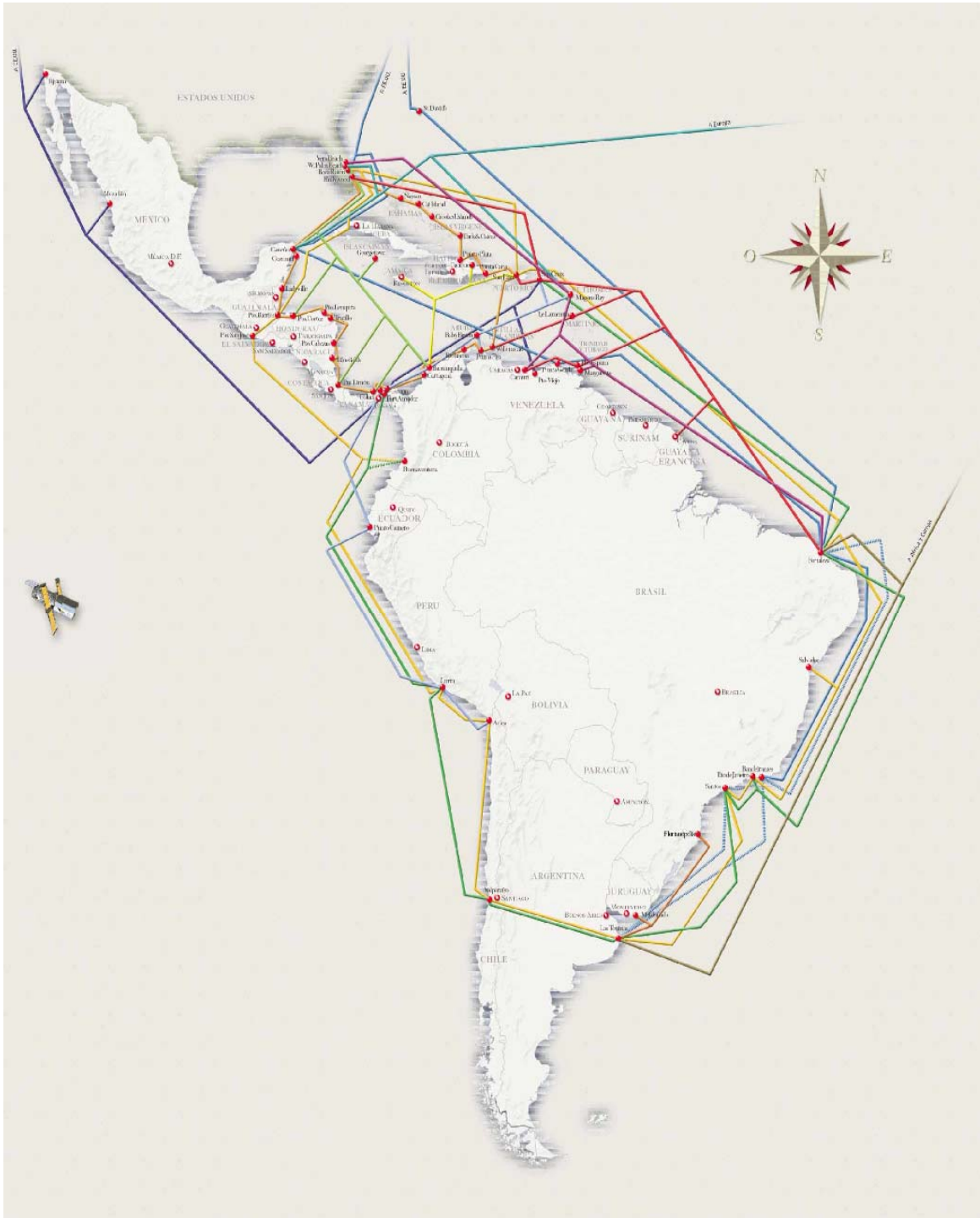
Mapa de las conexiones submarinas y terrestres de fibra óptica de la red Emergia, de Telefónica. La conexión terrestre sigue, prácticamente, la “frontera sur” que dividió al país en dos.
